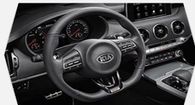
D-образен 3-лъчев спортен волан с перфорирана кожа
